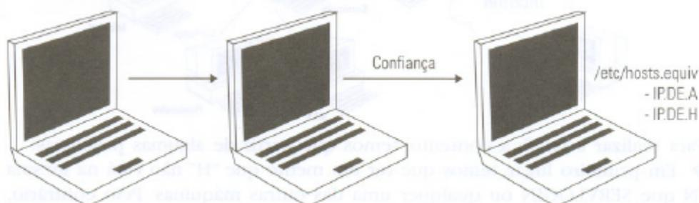
En el ejemplo anterior, todas las máquinas “S” y “T” son Unix. Las estaciones pueden ser cualquier cosa. En cada una de de máquinas “T” mostradas hay un archivo, */etc/hosts.equiv* que contiene la IP de “S”. Así, todos los usuarios que se logeen en “S” pueden tener acceso a los recursos de las máquinas “T”. Se pueden construir shell scripts
