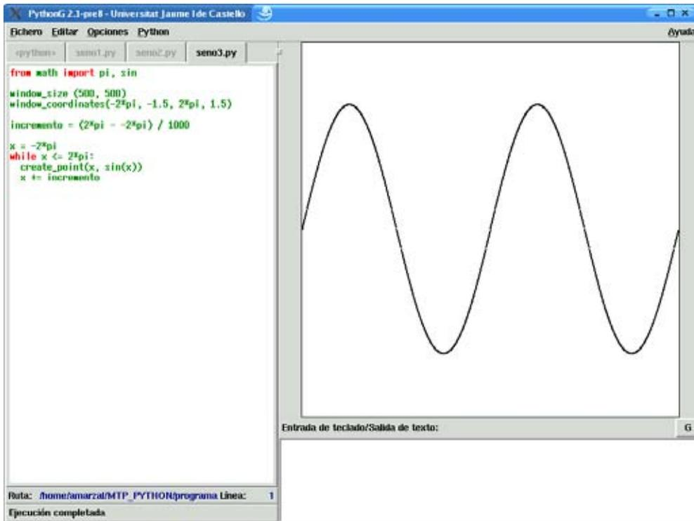
Figura 4.6: La función seno trazada con 1000 puntos.
