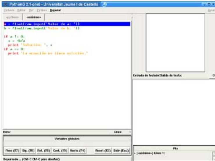
**Figura 4.1:** Modo de depuración activado. Aparecen dos nuevos marcos: uno bajo la ventana de edición y otro bajo la consola de entrada/salida. El primero incluye una botonera para controlar la ejecución del programa. En la ventana de edición aparece una línea destacada (la primera): es la siguiente línea a ejecutar.
