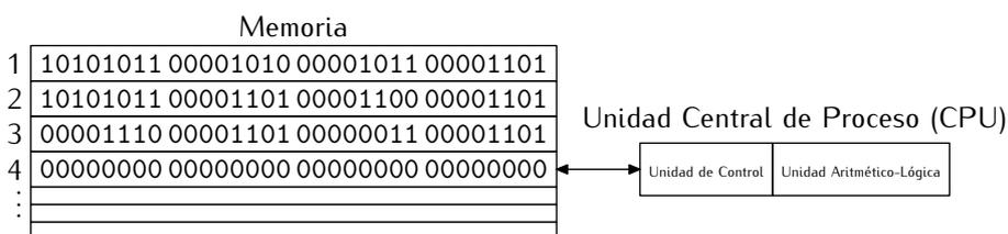
La CPU es un ingenioso sistema de circuitos electrónicos capaz de interpretar el significado de cada una de esas secuencias de bits y llevar a cabo las acciones que codifican. Cuando la CPU ejecuta el programa empieza por la instrucción contenida en la primera de sus posiciones de memoria. Una vez ha ejecutado una instrucción, pasa a la siguiente, y sigue así hasta encontrar una instrucción que detenga la ejecución del programa.
